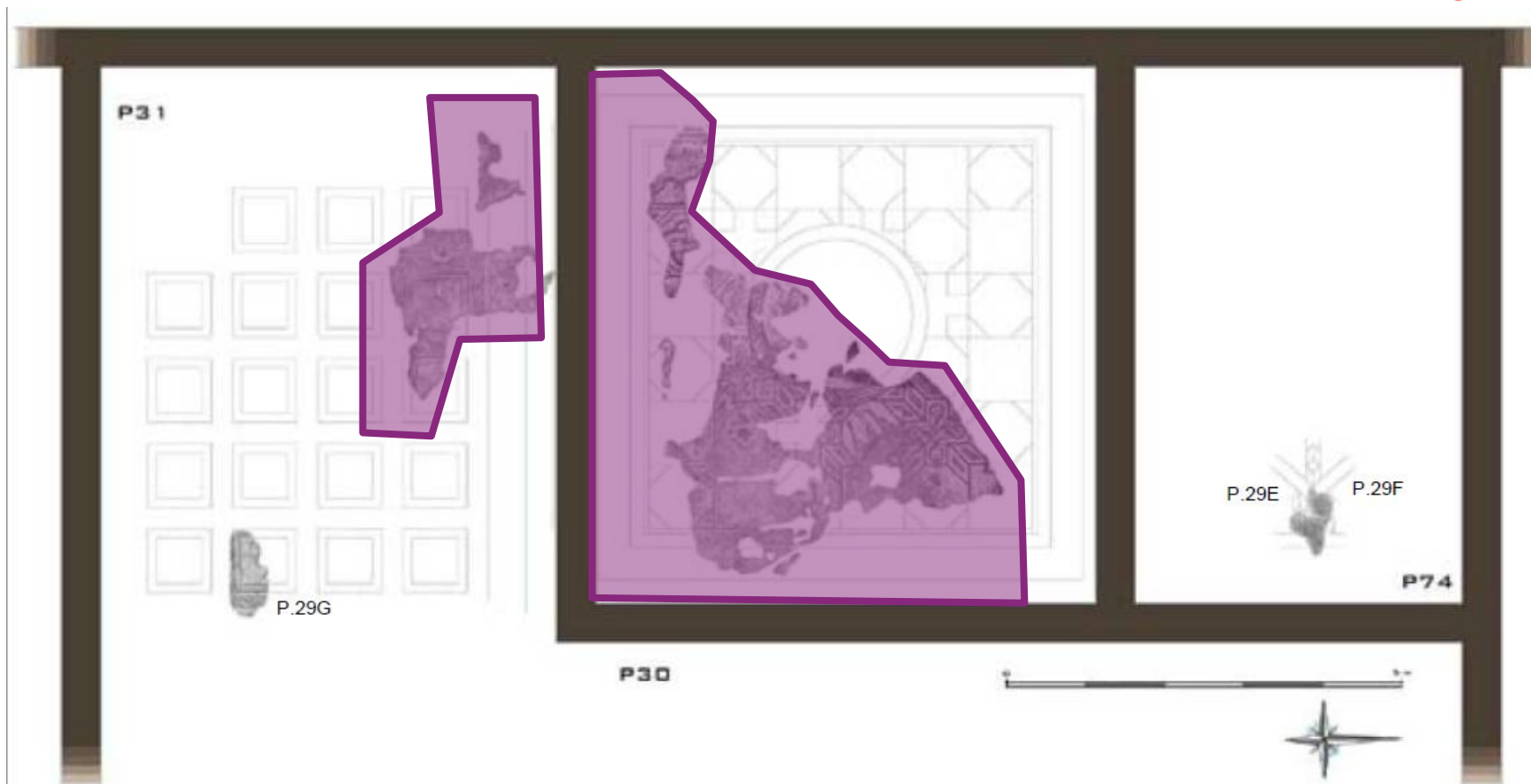
Fig. 70. Proposta ricostruttiva dei fr. musivi su soletta sospesa (P.30, P. 31 e P. 74) sulla base del rilievo MAN 469, secondo Pensabene e Gallochio. In viola le attuali solette di cui si prevede la demolizione.
