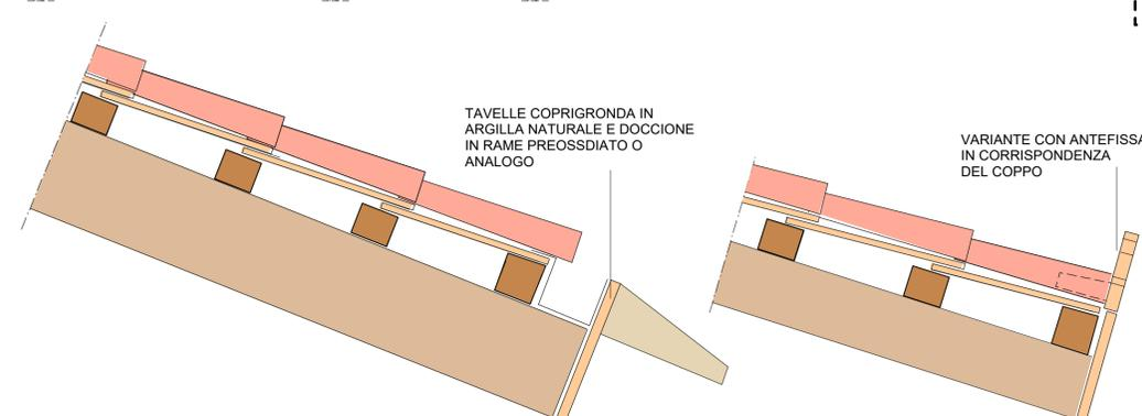
PARTICOLARE IN VARIANTE DEL CANALE DI GRONDA SEZIONE 1: 10
